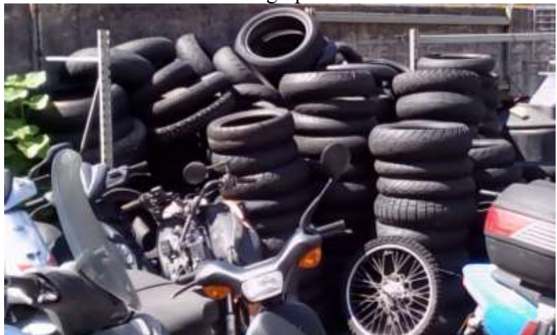
Figura 3, accumulo di gomme all'aperto e senza protezione dalle intemperie presso officina di Cannobio (VB).
