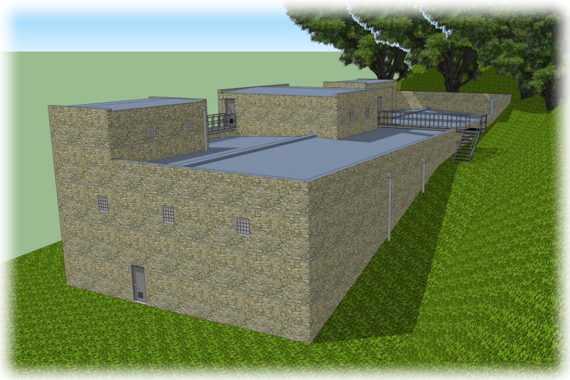
C.2 MITIGAZIONE SERBATOIO CON RIVESTIMENTO IN GEOPIETRA
