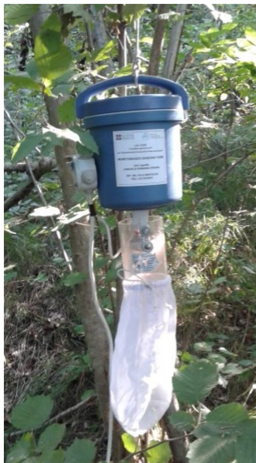
Figura 5, trappola alla CO 2 per il monitoraggio delle zanzare adulte.
